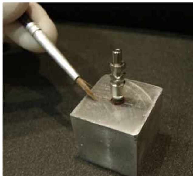
Figura 1 – Corpo-de-prova: Base metálica onde foi fixado o implante com resina acrílica autopolimerizável
