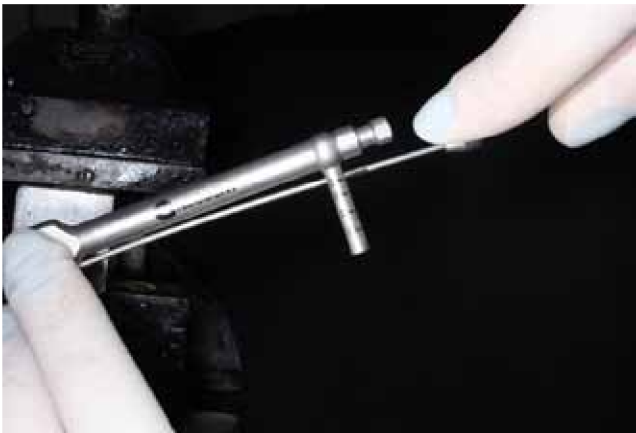
Figura 3 - Torque de 10N.cm com auxílio de um torquímetro.
