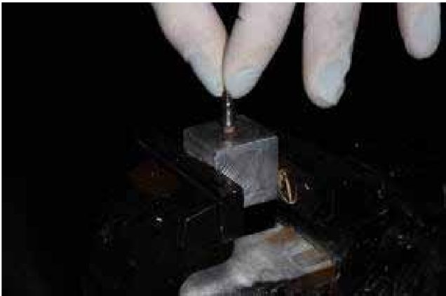
Figura 2 - Técnica do torque manual.
