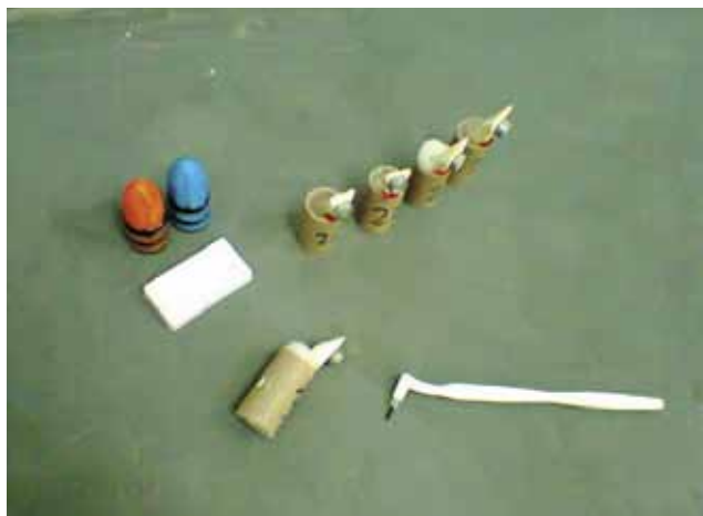
Figura 2 - Corpos-de-prova com as matrizes metálicas preenchidas com os cimentos resinosos
