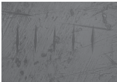
FIGURA 10 – Corpo de prova 2B demonstrando a superfície plana onde se realizaram as perfurações para leitura no microdurômetro
