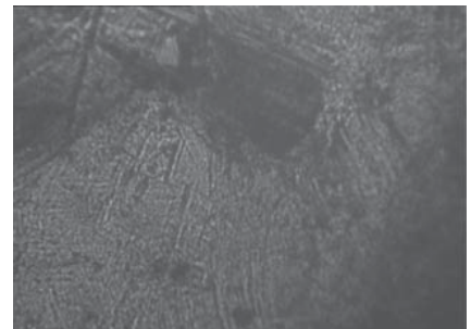
FIGURA 6 – Corpo de prova 3B, o qual não foi possível à realização de leitura no microdurômetro, pois o mesmo não apresentou uma superfície plana
