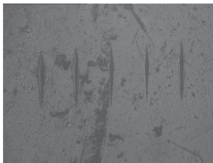
FIGURA 8 – Corpo de prova 1B demonstrando a superfície plana onde se realizaram as perfurações para leitura no microdurômetro
