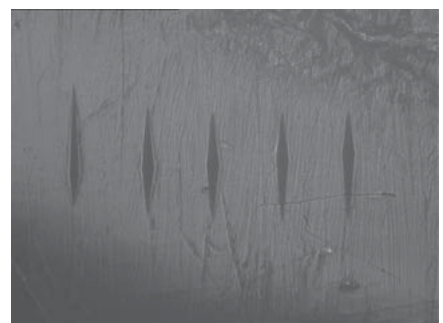
FIGURA 9 – Corpo de prova 2A demonstrando a superfície plana onde se realizaram as perfurações para leitura no microdurômetro
